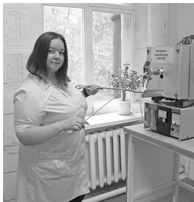
► Татьяна Семерьянова проводит определение углерода кулонометрическим методом на экспресс-анализаторе АН7529
