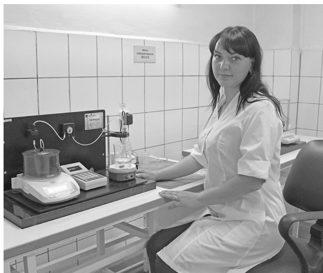
► Алена Бритова проводит определение ферросиликомарганца потенциометрическим методом на титраторе «Титрон»
