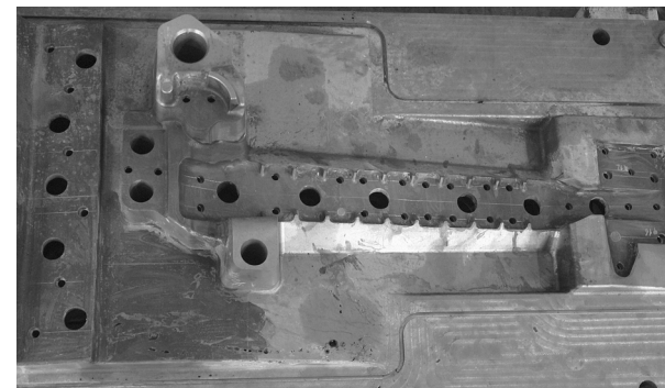
► Готовая верхняя часть стержневого ящика корпуса Автосцепки
