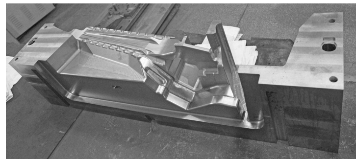
► Готовая левая боковая часть стержневого ящика корпуса Автосцепки
